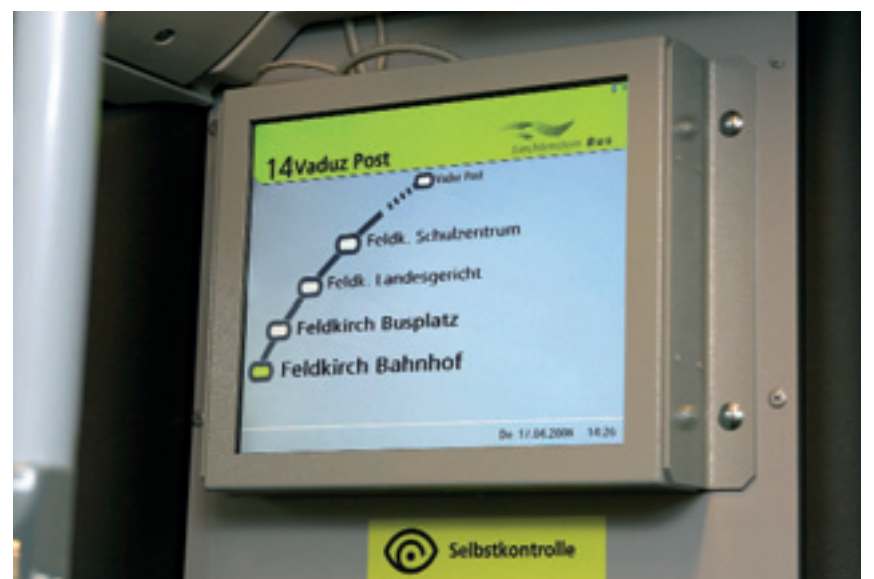
Dynamische Fahrgastinformation: Standort- und Fahrzeitbestimmung dank neuer Bordelektronik in LBA-Bussen. Bild: pd
